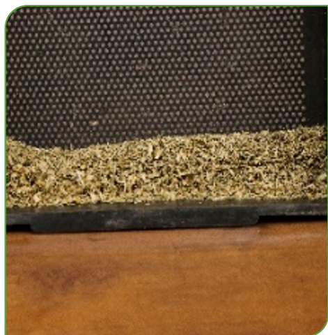
Figura 4. Resultado de avaliação de silagem de milho com uso do conjunto de peneiras Penn State. Em ordem: 19 mm; 8 mm; 4 mm e fundo. Fotos: Syngenta Seeds.
